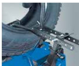
Настройка устройства расширения
