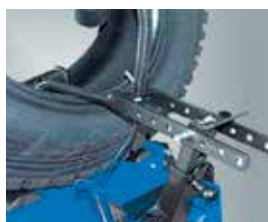
Настройка устройства расширения
