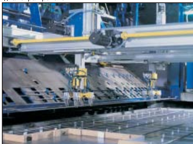
Автоматические системы армирования с роботом для укладки стали для продольных и поперечных опор (для элементных перекрытий, двойных стен и монолитных плит)
