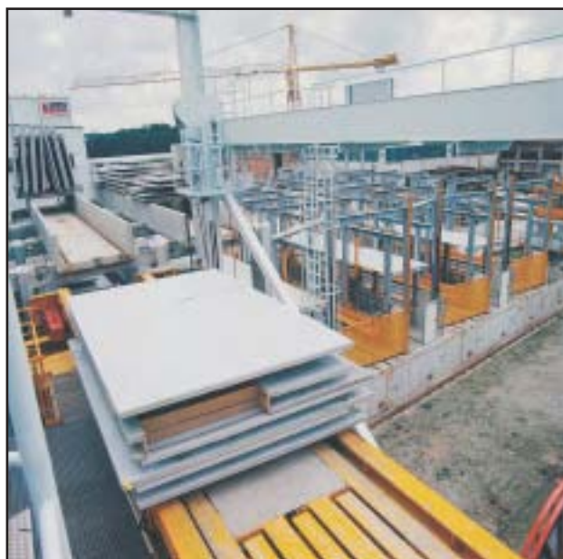
Полностью автоматическое устройство для обслуживания стеллажей с подъемной траверсой и тележкой
