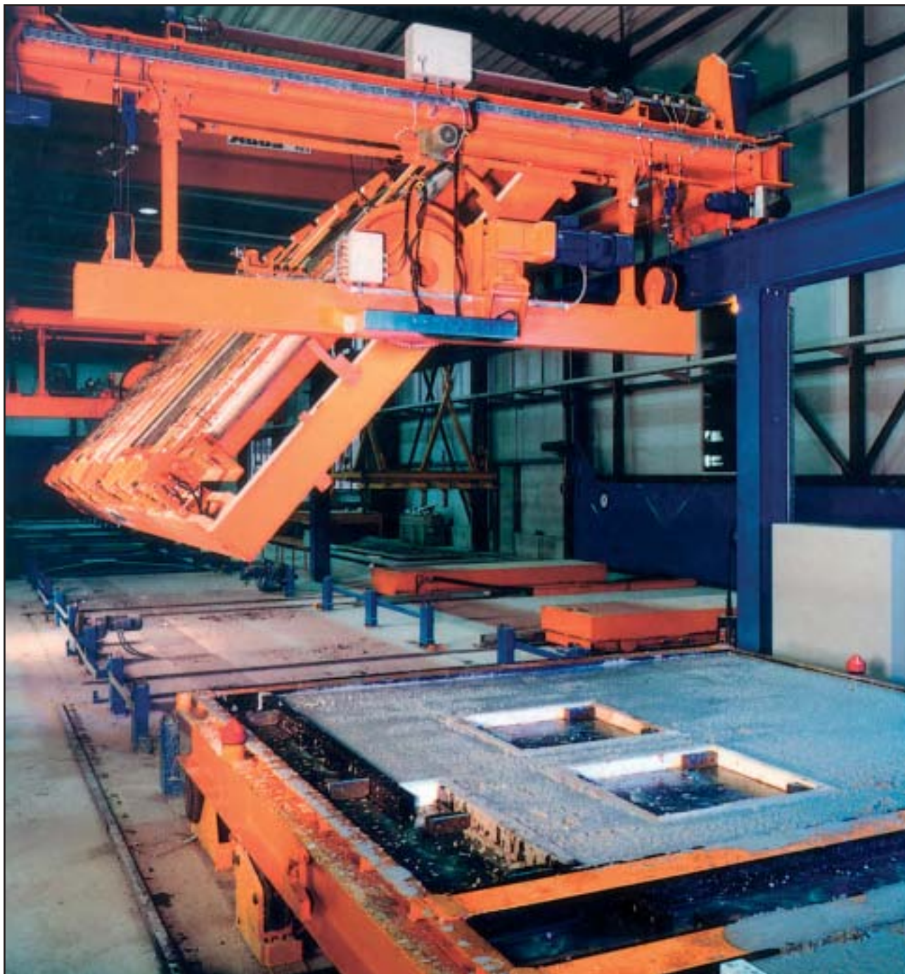
Обслуживаемый краном поворачивающий автомат с оборотным поддоном
