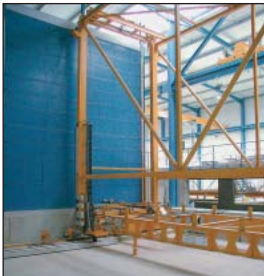
Устройство загрузки камеры для затвердения в шахте, упорядоченное с закрытой камерой для затвердения
