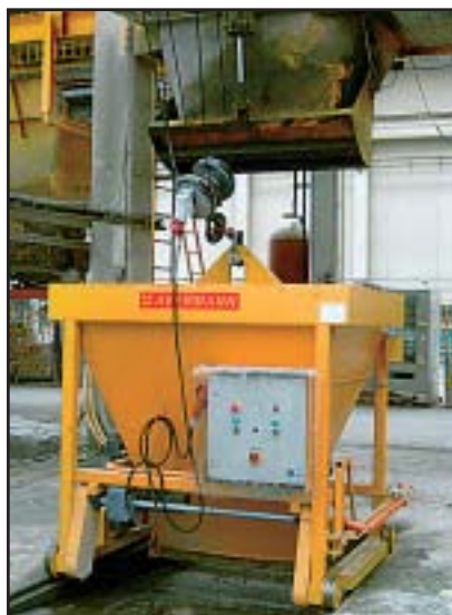
Ковш для бетонной смеси с электромотором механизма прмщния
