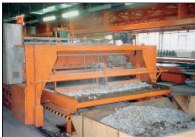
Очистительная машина с мостовым ходовым механизмом
