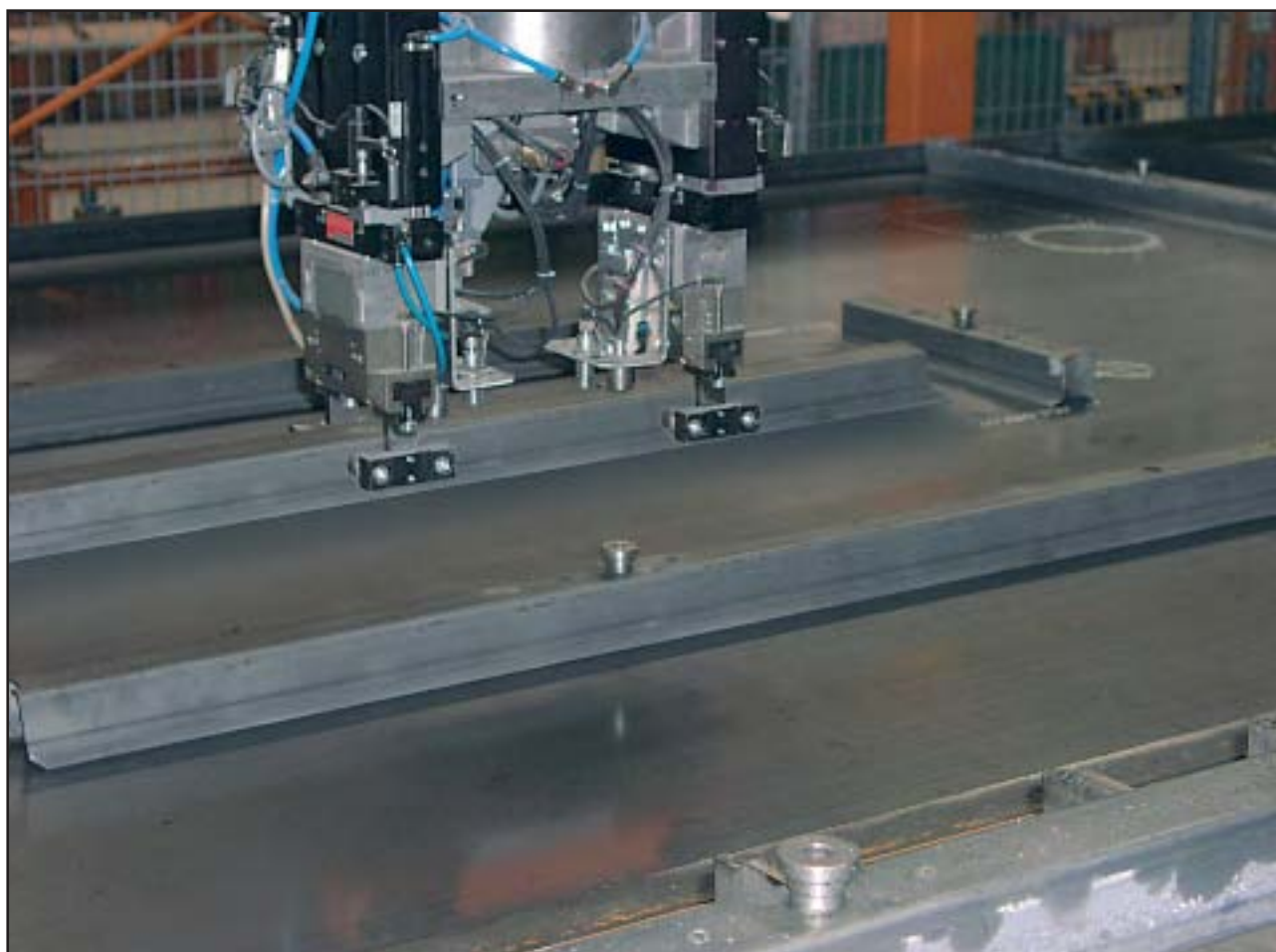
Робот для установки опалубки в действии
