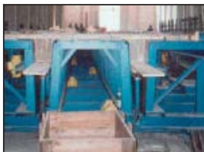
Механически регулируемая опалубка типа «ТТ» с регулировкой высоты пола
