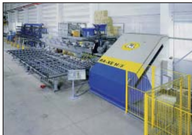
Ротационно-правочные и резальные машины для арматурной стали из бухты (ш 6 мм - ш 16 мм) с быстрой сменой диаметра проволоки
