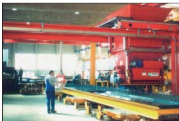
Мостовой бетонораздатчик с поперечным движением ковша
