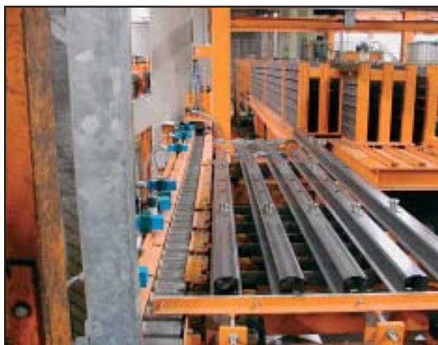
Роликовый конвейер для опалубочного материала с определением длины
