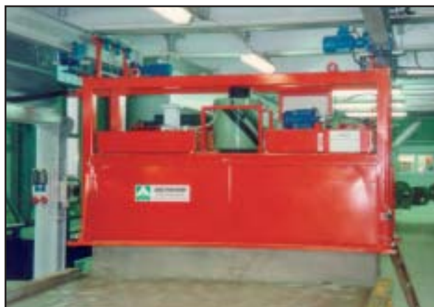
Передвижная машина для смазывания маслом с ходовым механизмом мостового типа
