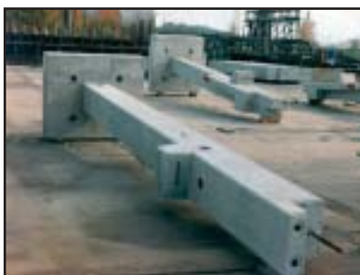
Колонна с литой фундаментной плитой
