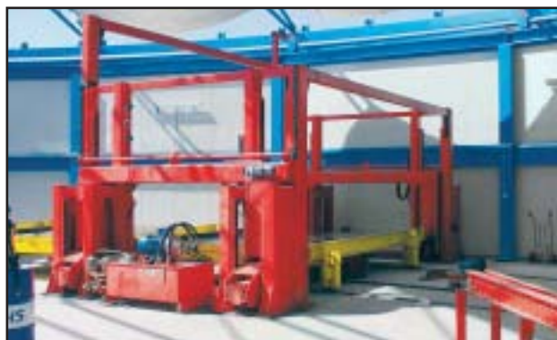
Передвижное приспособление для установки двойных стен в вертикальное положение
