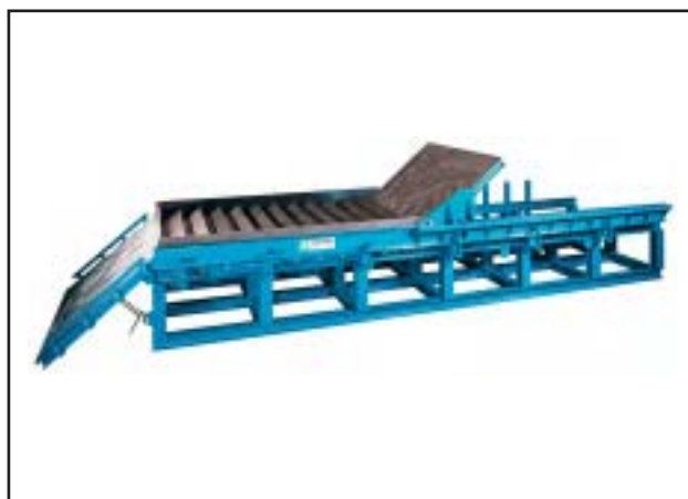
Регулируемая опалубка для «негативного» производства
