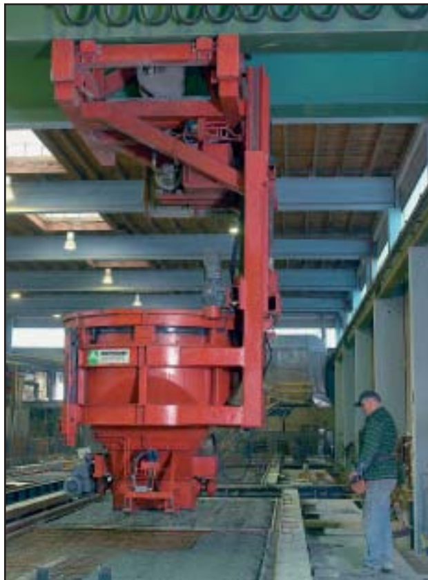
Закреплённый на кране бетонораздатчик с дистанционным радиоуправлением
