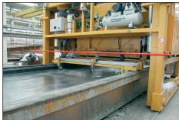
Комбинированная машина для очистки/вычерчивания кривых/распыления [R/P/E]
