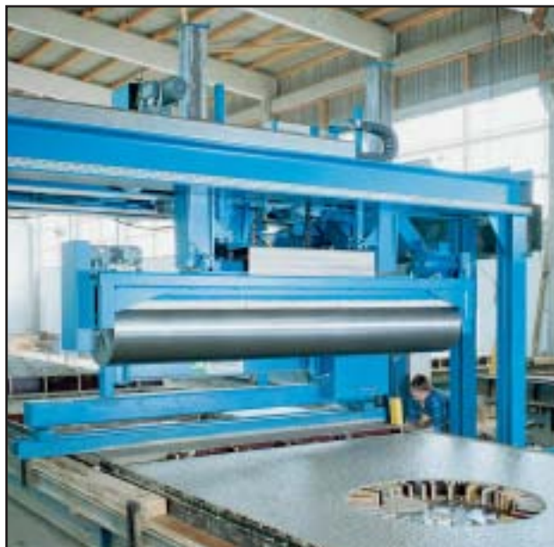
Комбинация выравнивающего приспособления с разравнивающим вибрационным валом
