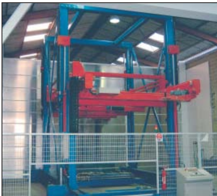
Гидравлическое устройство загрузки камеры для отверждения
