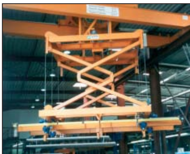
Горизонтальный подъем двойных стен
