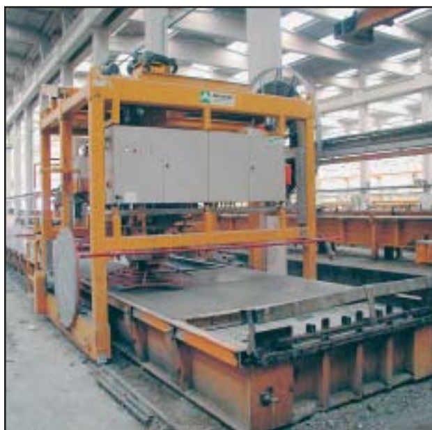
Лопастное выравнивающее устройство портального типа
