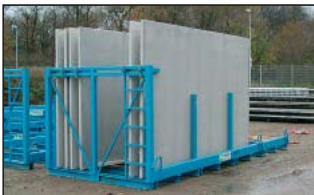
Стеллаж для транспортировки двойных стен
