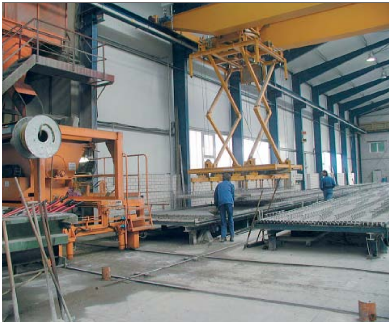
Производство элементных перекрытий
