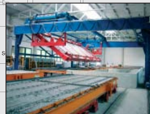
Передвижной поворачивающий автомат portalного типа
