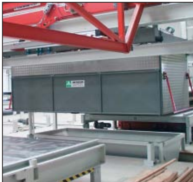
Комбинированная машина для очистки и распыления
