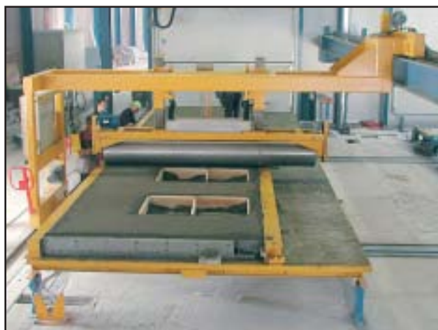
Разравнивающий вибрационный вал полупортального типа
