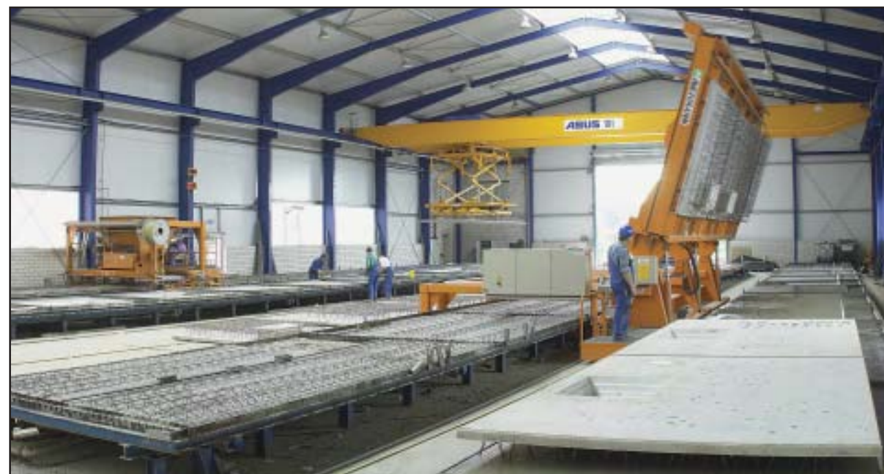
Передвижной поворачивающий автомат с системой вакуумного всасывания
