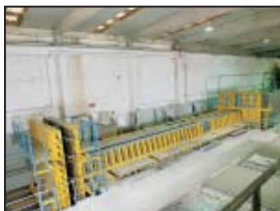
Сдвоенная опалубка для колонн с опалубкой для основания
