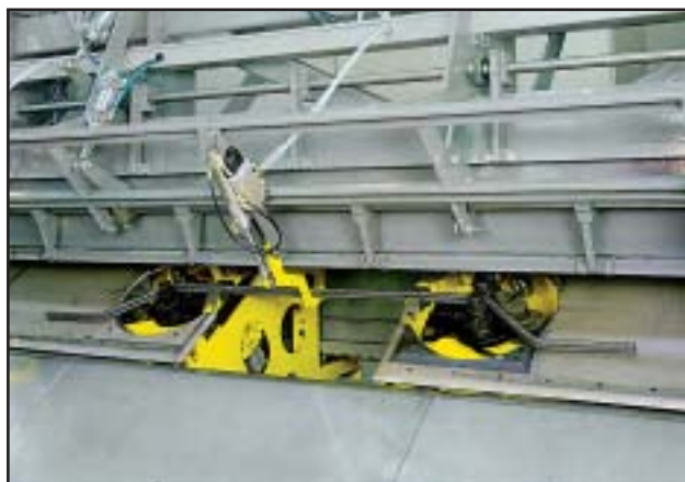
Ротационно-правочные и резальные машины для арматурной стали из бухты (ш 6 мм - ш 16 мм) с быстрой сменой диаметра проволоки
