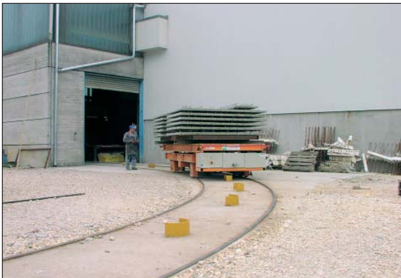
Тележка для вывоза продукции с потолочными плитами
