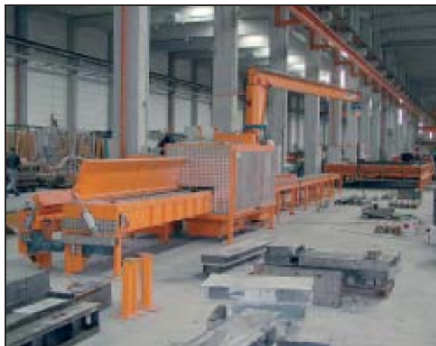
Машина для очистки опалубки для потолочных плит/двойных стен
