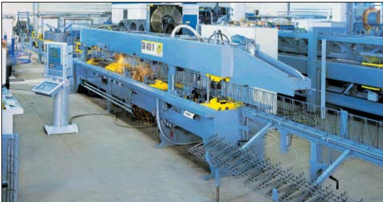
Машина для сварки решетчатых опор
