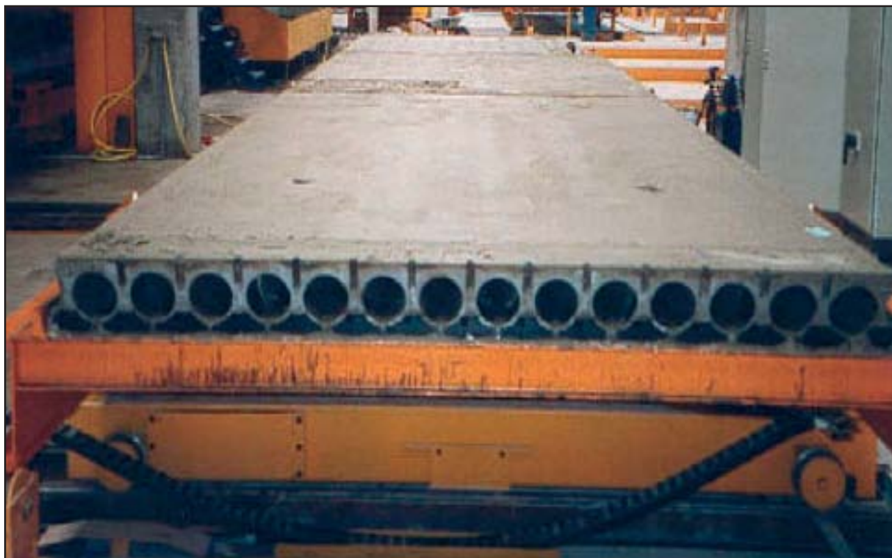
После выхода из трубовытягивающей установки
