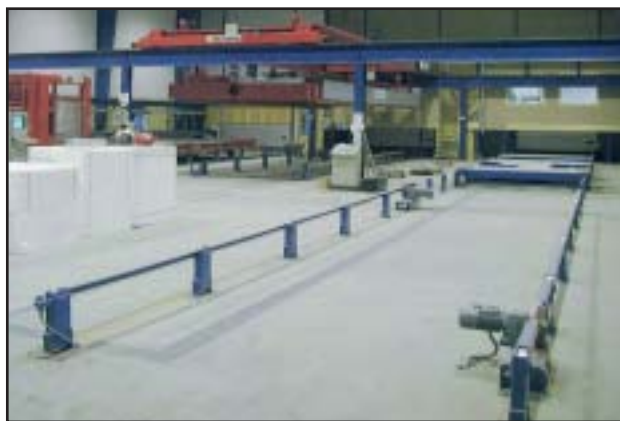
Ролики на рамных опорах с фрикционным приводом
