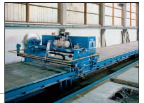
Конвейерный прибор для вычерчивания кривых (BEMF)
