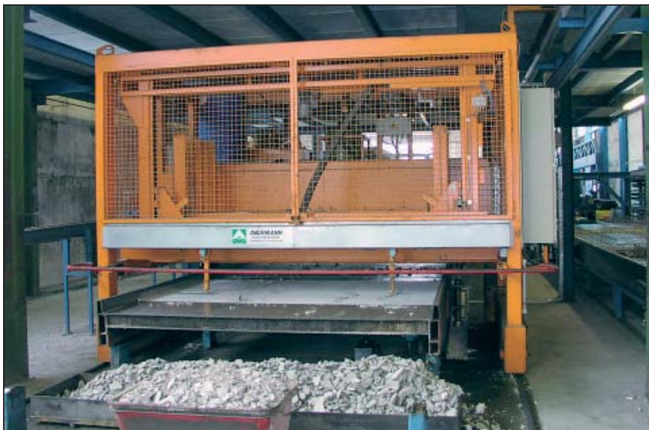
Комбинированная машина для очистки/вычерчивания кривых/распыления [Q/R/P/E]
