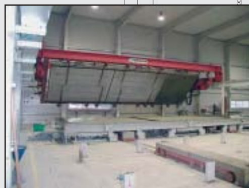
Передвижной поворачивающий автомат мостовой конструкции
