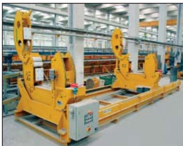
Устройство для поворота колонн для их последующей обработки как, например, крепление консолей
