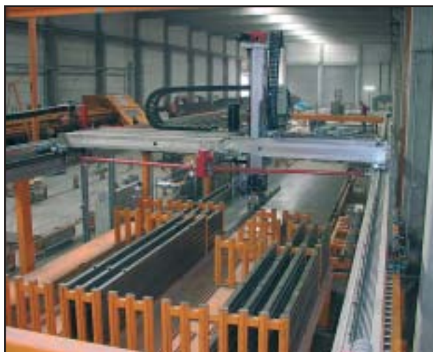
Робот для установки опалубки - Общий вид
