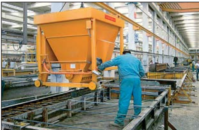
Ковш для бетонной смеси с приспособлениями для захвата вилочным погрузчиком
