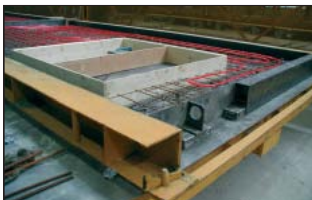
Системы опалубок с магнитами для монолитных стен
