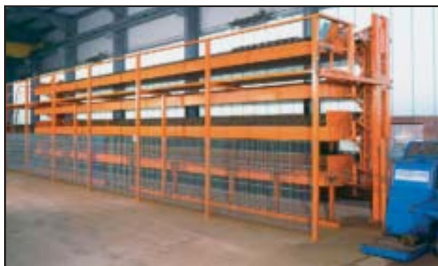
Подъемник непрерывного действия для решетчатых опор « AVERMANN » для компактного хранения пакетов решетчатых опор
