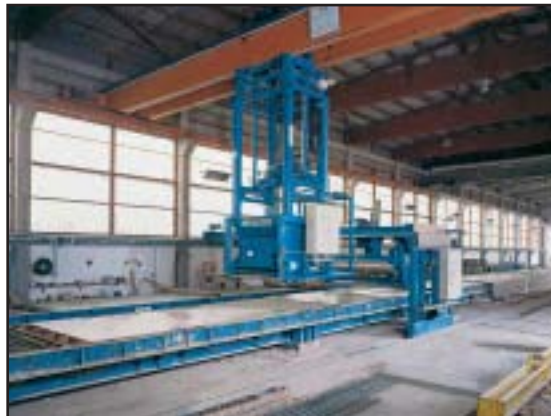
Бетонораздатчик на кране
