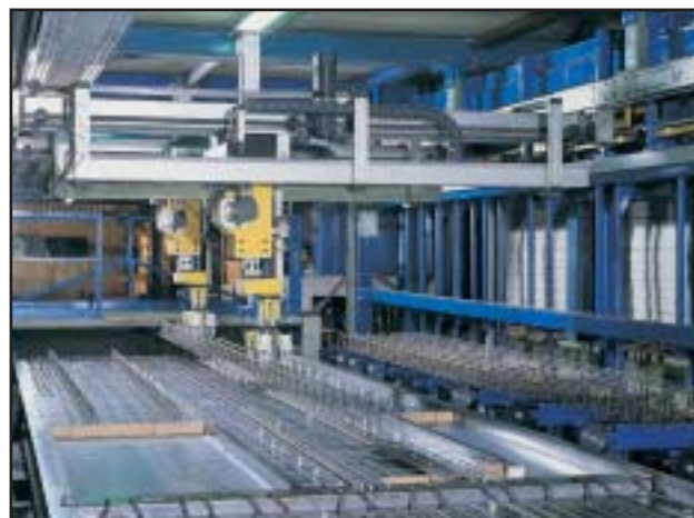
Автоматические системы армирования с роботом для укладки стали для продольных и поперечных опор (для элементных перекрытий, двойных стен и монолитных плит)
