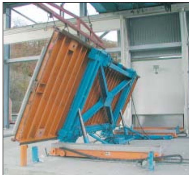
Опрокидывающая станция (задняя сторона)
