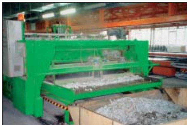
Комбинированная машина для очистки и распыления
