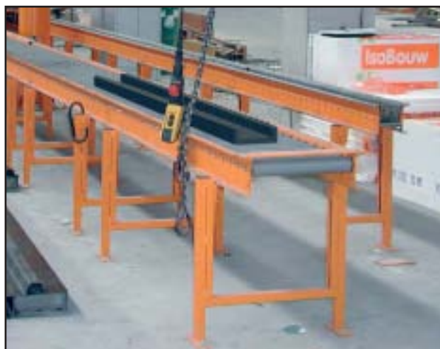
Роликовый конвейер для транспортировки опалубочного материала
