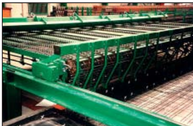
Системы укладки продольных и поперечных прутков (для потолочных плит)
