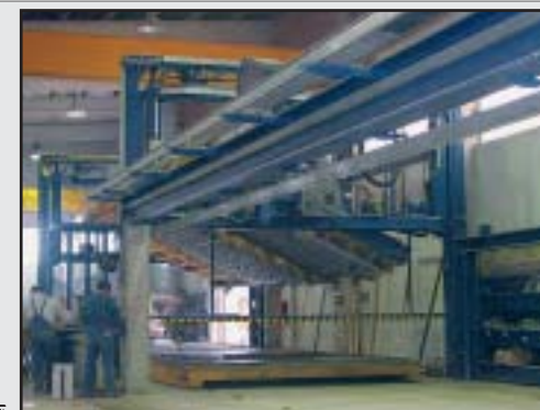
Стационарный поворачивающий автомат с вакуумным оборудованием и отцеplяемой поворачивающей траверсой
