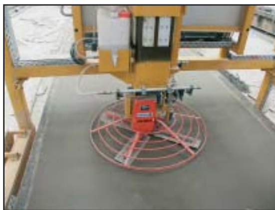
Лопастное выравнивающее устройство, детально
