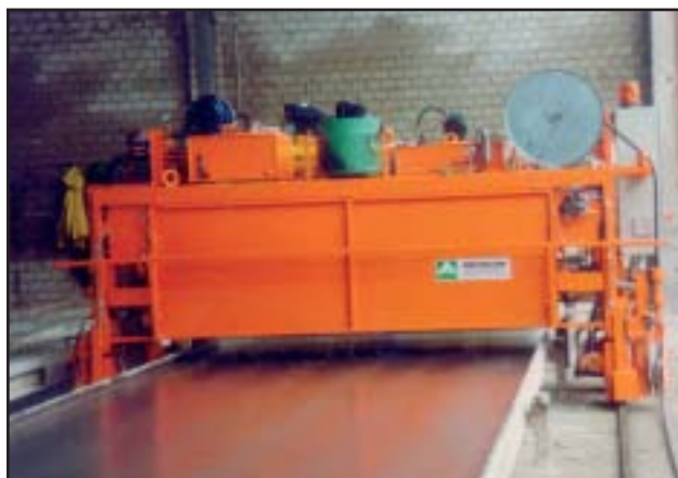
Передвижная машина для смазывания маслом с ходовым механизмом наземного типа
