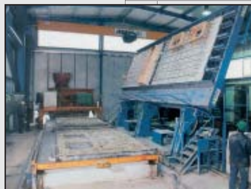
Стационарный поворачивающий автомат с системой вакуумного всасывания
