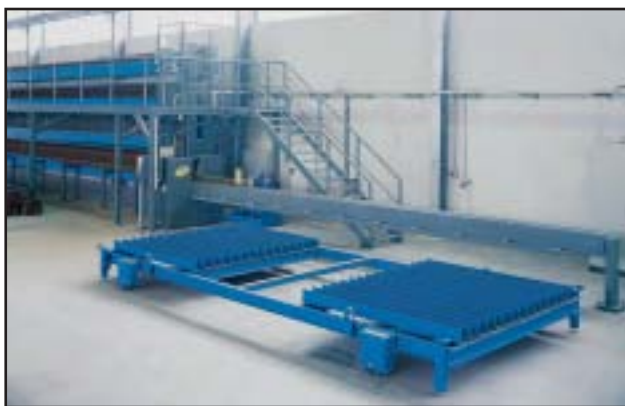
Установка для резания решетчатых опор и опорные системы
