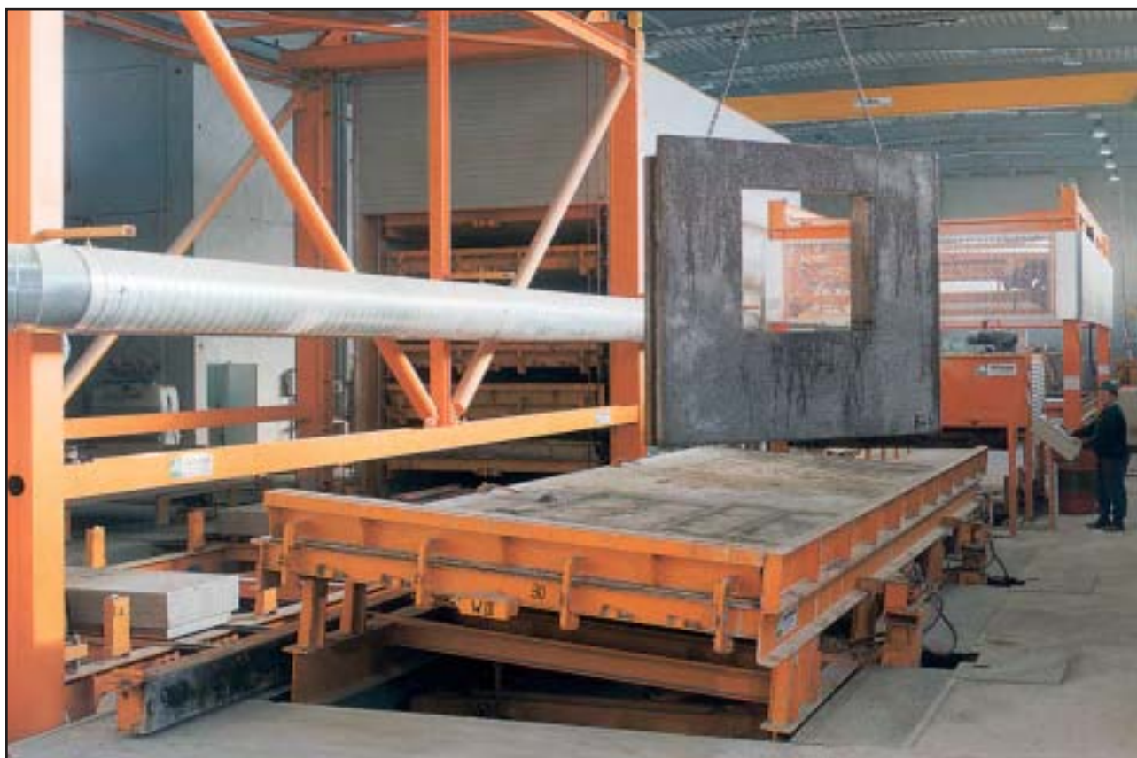
Опрокидывающая станция с оборотным поддоном
