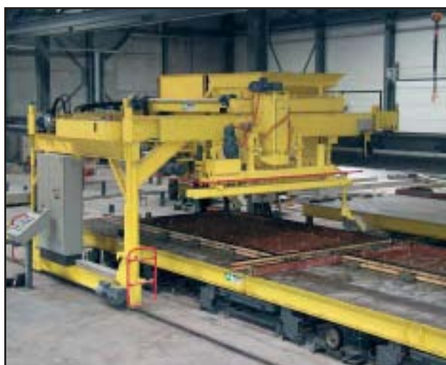
Полупортальный бетонораздатчик с двумя отдельными ковшами
