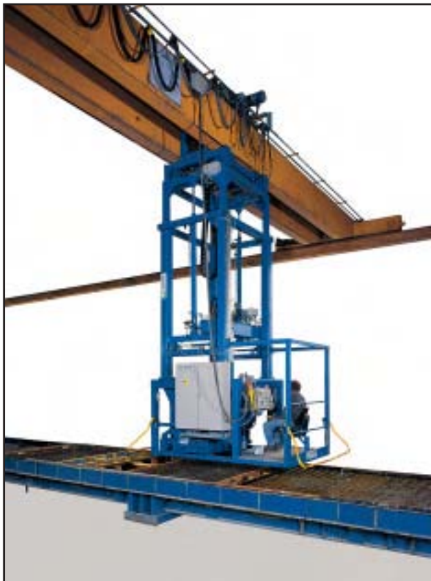
Закреплённый на кране бетонораздатчик с кабиной управления
