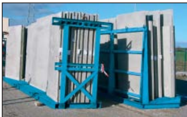
Стеллаж для транспортировки монолитных стен
