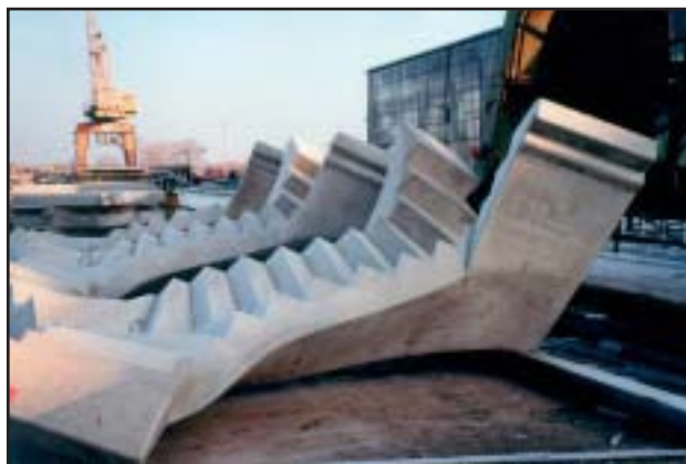
Винтовая бетонная лестница
