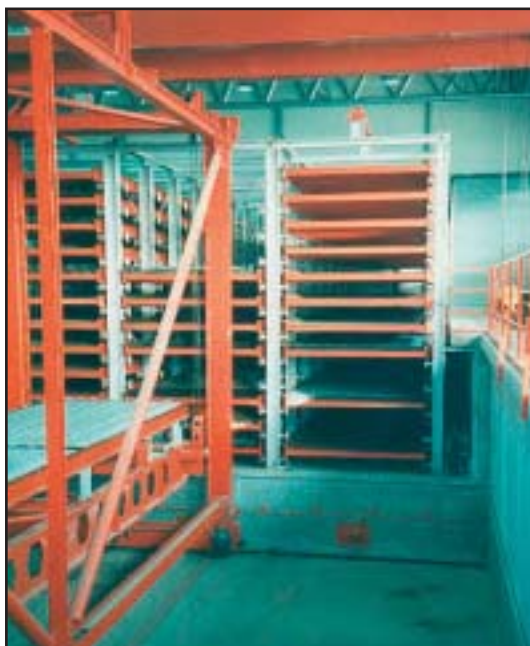
Устройство загрузки камеры для отверждения в шахте, установленное с открытой камерой для отверждения
