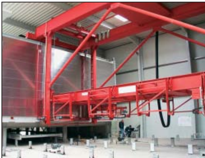
Устройство загрузки камеры для отверждения с траверсой для захвата сверху (шахта не нужна)
