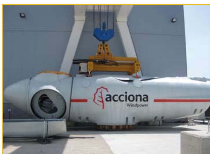
Траверса до 160 тонн с гидравлическим устройством на фабрике ветро-генераторов.
