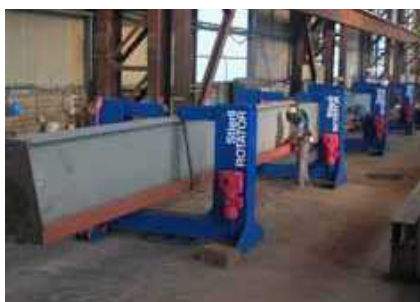
Использование нескольких кантователей для очень длинных деталей
