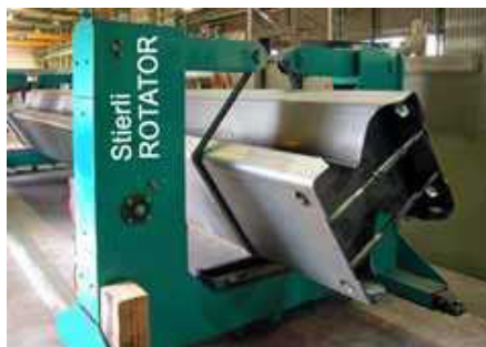
Выполнение заземления детали при помощи цепи
