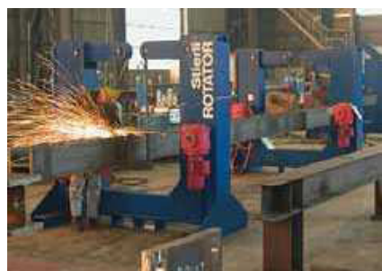
Регулируемая рабочая высота +2 направления вращения кантователя
