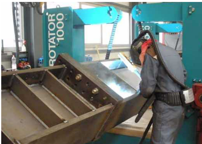
Сварка и зачистка поверхностей в удобном для сварщика положении
