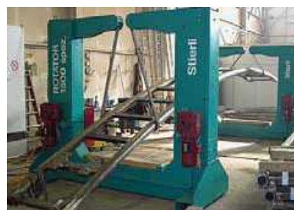
Надежная фиксация с помощью цепи при вращении детали в кантователе
