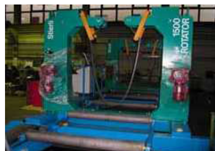
Кантователь встроенный в сварочную установку
