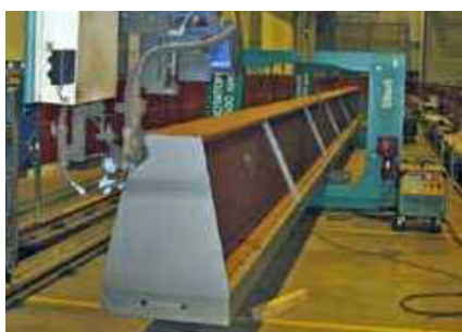
Кантователь сварочный в комбинации со сварочным роботом
